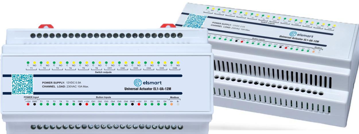
EL1-UA-12M universal aktuatoru, eyni anda 12 müxtəlif qurğunu və yükü idarə etmək üçün hazırlanmış çoxfunksiyalı bir cihazdır. EL1-UA-12M 12 müstəqil normal açıq (NA) quru kontaktlı releyə malikdir və 12V sabit cərəyanla işləyir. Hər bir çıxış kontaktı ayrı-ayrılıqlıda idarə oluna və ünvanlana bilər ki, bu da ćevik və funksional həll deməkdir.
