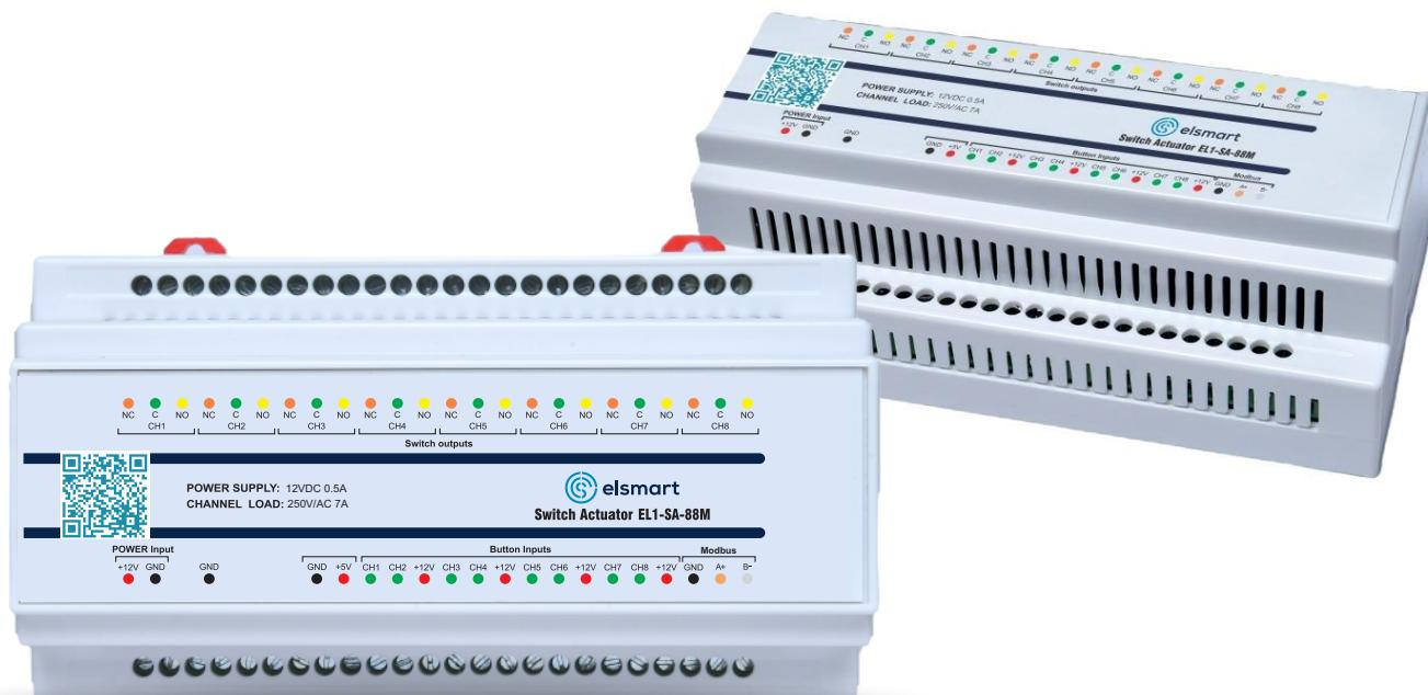
EL1-SA-88M kommutasiya aktuatoru, eyni anda 8 müxtəlif qurğunu və yükü idarə etmək üçün hazırlanmış çoxfunksiyalı bir cihazdır. EL1-SA-88M 8 müstəqil normal açıq (NA) quru kontaktlı releyə malikdir və 12V sabit cərəyanla işləyir. Hər bir çıxış kontaktı ayrı-ayrılıqlıda idarə oluna və ünvanlanara bilər ki, bu da çevik və funksional həll deməkdir.
